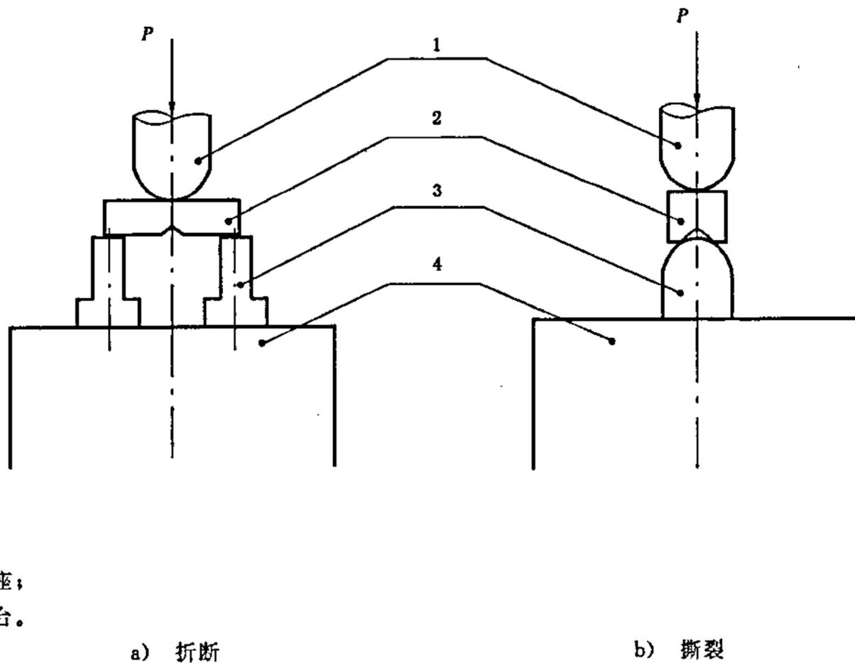
图 1 断口试验示意图
